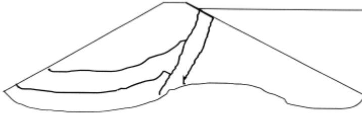
FIG.5 - TUBIFICACION (EROSION INTERNA) A TRAVES DE GRIETAS EN EL TERRAPLEN ORIGINADA POR ASENTAMIENTOS DIFERENCIALES
