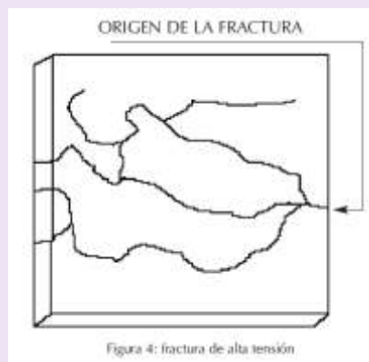
Fig. 7.6: fractura por stress térmico de alta tensión
